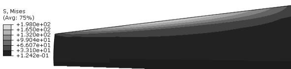
Рис.7 Напряжения и деформирование пенопластового наполнителя при параллельной ориентации лопасти относительно набегающего потока
