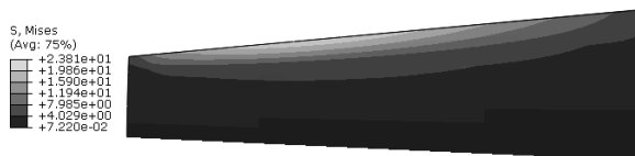
Рис.6 Напряжения и деформирование пенопластового наполнителя при параллельной ориентации лопасти относительно набегающего потока
